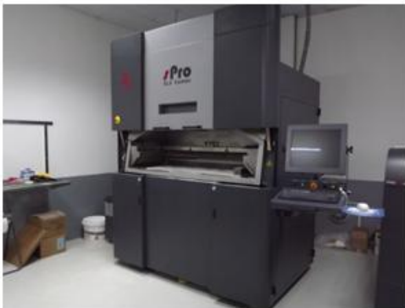
Laboratório de Prototipagem Rápida (Equipamento SLS 3DSystem sPro)
