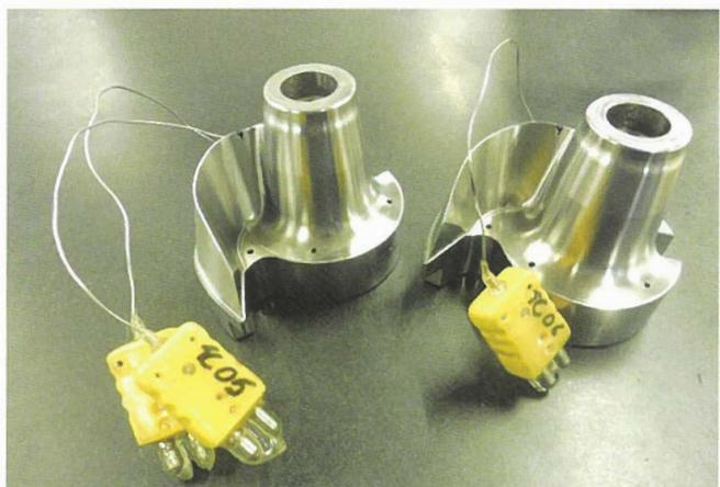
// Figura 4. Componentes com sensores embutidos no processo de fabrico aditivo.
